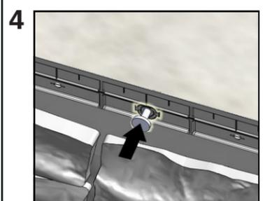
**Při montáži celého panelu umístěte vrt do jeho středu**
