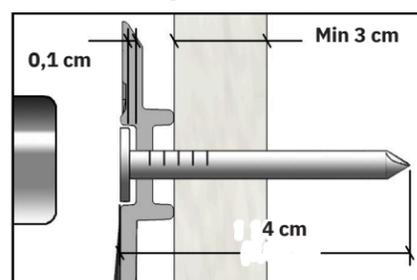
**Při montáži zkráceného panelu upevněte vrt do jeho středu**
