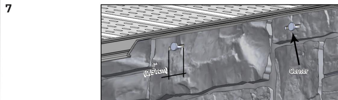
**Pokud upevňujete panel na jiném místě než jsou standartní instalační otvory - vytvořte podélný otvor o délce 2,5 cm a vrt šroubujte do středu otvoru.**
